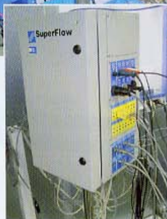
Voll verkabelt: Bis zu 25 verschiedene Messwerte greift Tuningprofi Lautner bei Abstimmungsmaßnahmen ab – teilweise mit Hilfe zusätzlicher Sensoren. In der Sensor- und Kontrollbox (kleines Bild) laufen sämtliche Werte zusammen und werden auf einen einheitlichen Standard gebracht. Mit Hilfe des regelbaren Kühlturms (Pfeil) bleiben die Temperaturen während der Testprozedur im ‚grünen Bereich‘.
