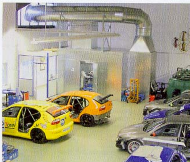
Leistungszentrum: Die silberne Testbox (hinten links) ist so gut schallisoliert ... von ‚LMS Engineering‘ ohne Lärmbelästigung an der übrigen Cup-Armada ... grünen Tanks (Pfeil) ist das Wasser für die Leistungsbremse des Motorenpr ... Abwärme im Winter einen Teil der Halle beheizt.
