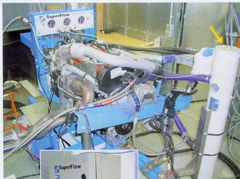
Voll verkabelt: Bis zu 25 verschiedene Messwerte greift Tuningprofi Lautner bei Abstimmungsmaßnahmen ab – teilweise mit Hilfe zusätzlicher Sensoren. In der Sensor- und Kontrollbox (kleines Bild) laufen sämtliche Werte zusammen und werden auf einen einheitlichen Standard gebracht. Mit Hilfe des regelbaren Kühlturms (Pfeil) bleiben die Temperaturen während der Testprozedur im ‚grünen Bereich‘.
